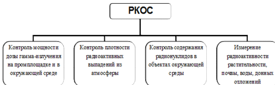
Рис. 6.5. Общий вид подсистемы радиационного контроля окружающей среды на ЗАЭС
